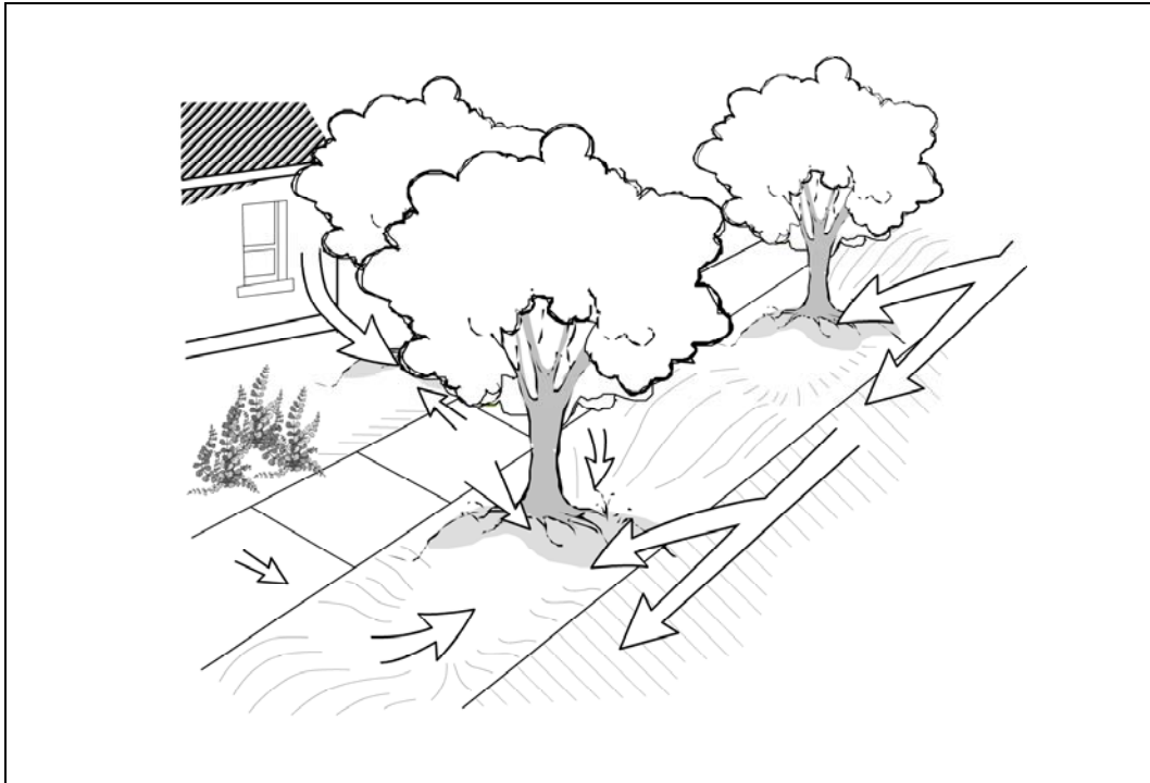
Figur 3.2 Regnvand fra fortove og stier strømmer af til regnbede med træer
